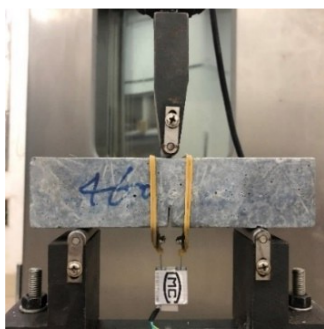
(b)三点弯曲断裂试验装置
