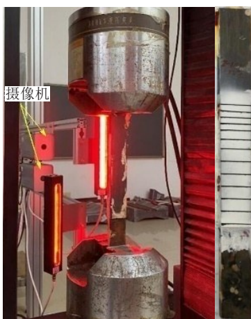
图6 CFRP-钢双搭接试件拉伸剪切性能试验
