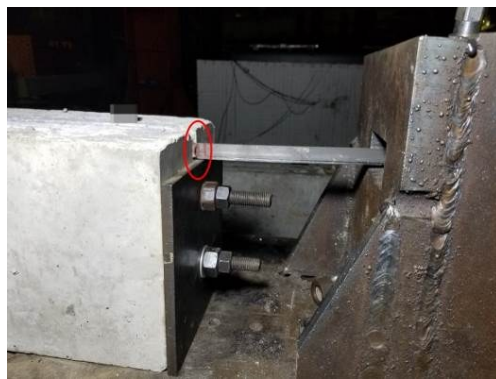
图5 NSM试件破坏形态
