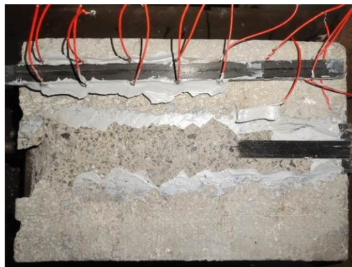
图4 EB试件破坏形态
