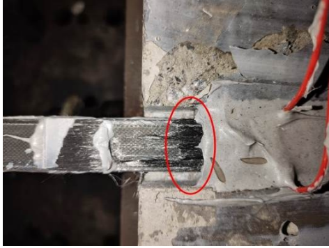
图6 HE-15试件破坏形态
