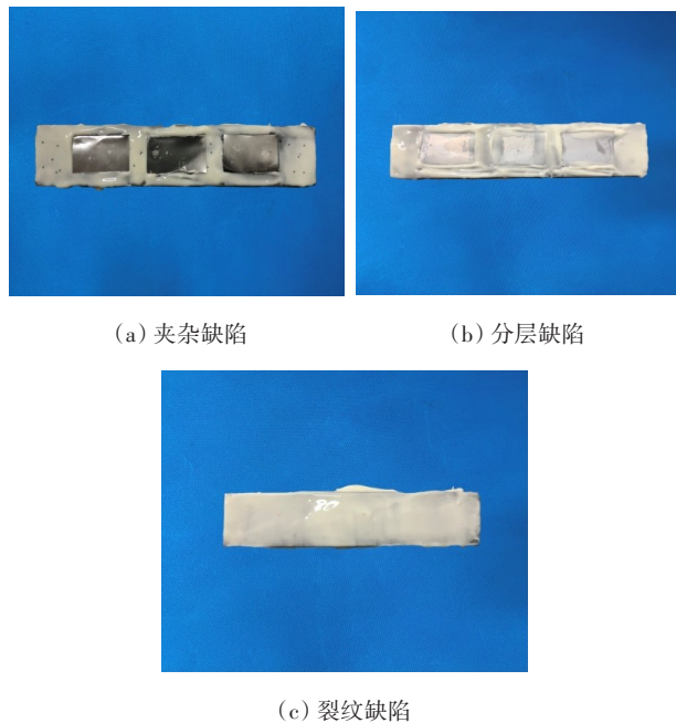
图1 3种缺陷黏接板
