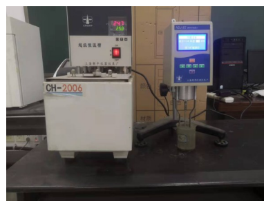
图4 浸渍胶黏度测量试验
