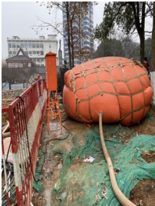
图 14 堆载试验
