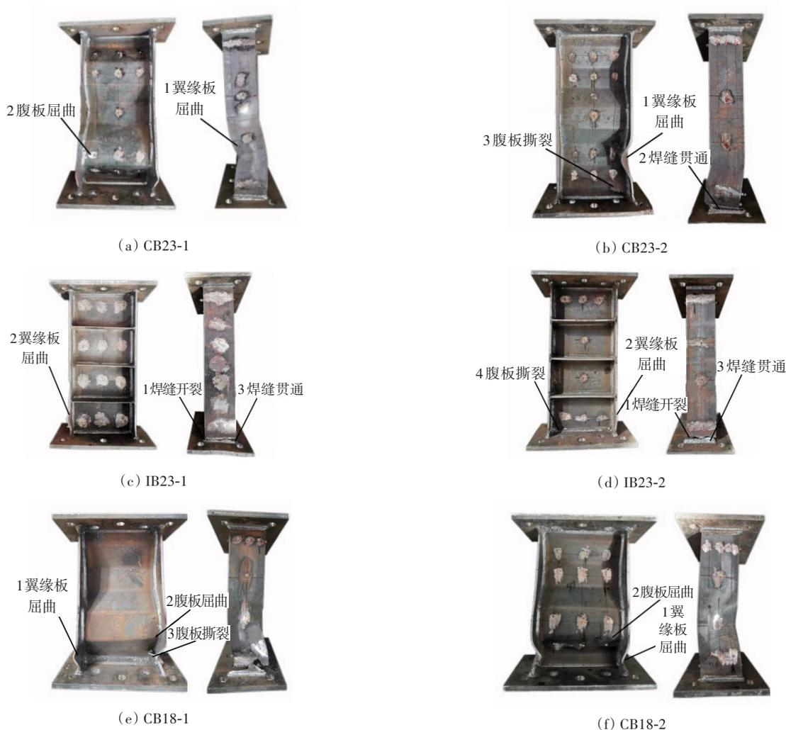
图7 试件破坏形态
