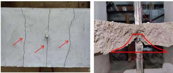
(a) 顶板裂缝 (b) 隔板冲切破坏
