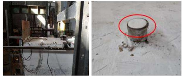
(a) 试验加载 (b) 桩头鼓胀破坏
