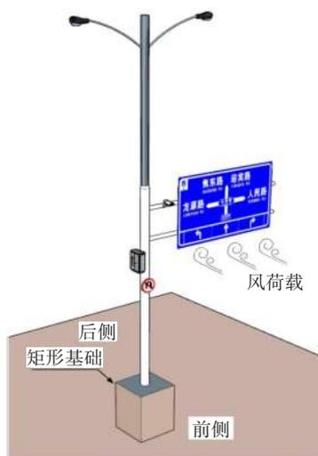
图1 多杆合一杆件刚性矩形基础简化受力模型<sup>[16]</sup>
