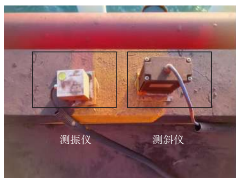
图5 测振仪、测斜仪安装的具体位置
