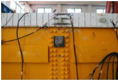
图7 混凝土应变测试
