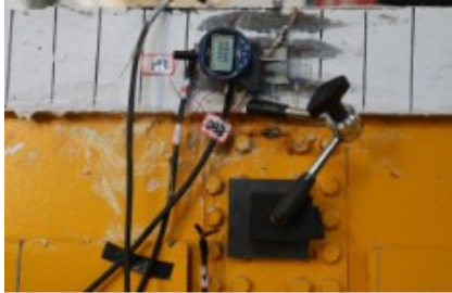
图6 组合界面滑移测试
