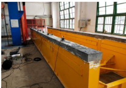
图8 组合梁动力特性测试
