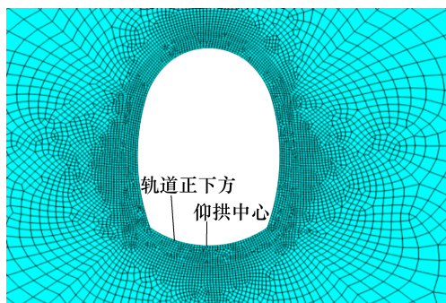
图4 隧底结构特征点示意
