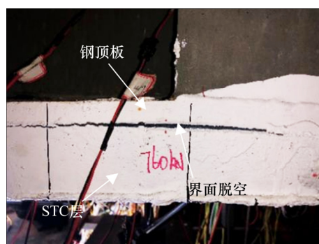
图 7 STC 层与钢顶板发生脱离
