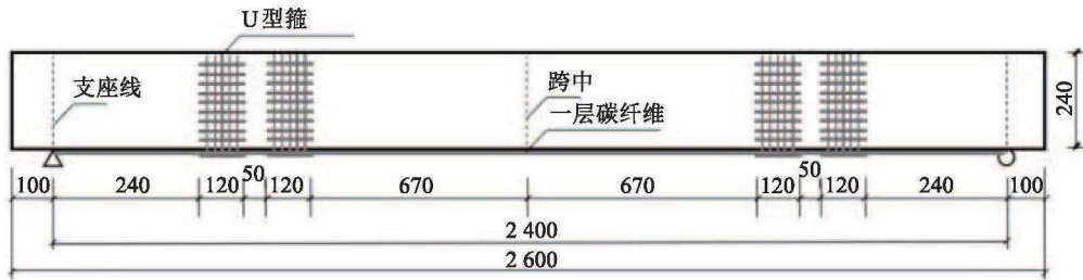
图2 梁加固方式 (单位: mm)
