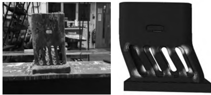
(b)开孔板条塑性变形
