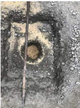
图 1 分层检测压实度
