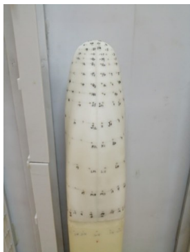
图7 列车测压孔位布置
