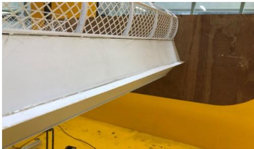
图5 在上下腹板间设置水平分流板(工况1)
