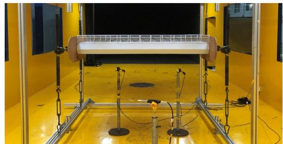
图3 风洞试验主梁模型
