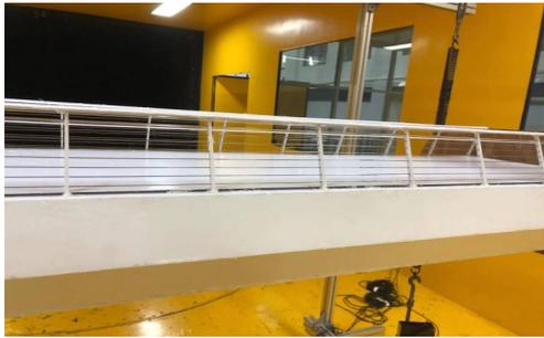
图13 改变栏杆外形+两侧向外安装0.3 m长的风嘴试验布置图
