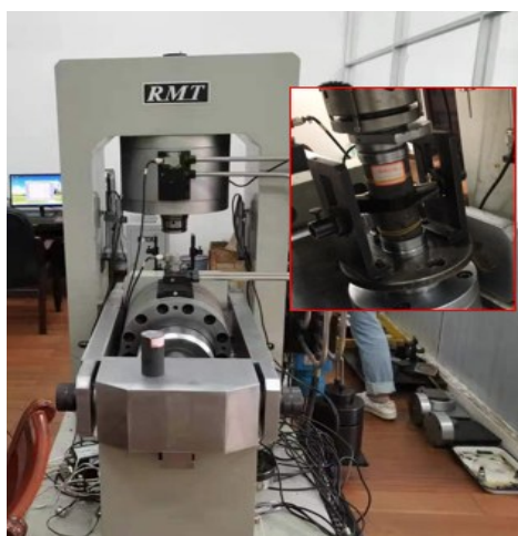
(b) RMT-150C 试验装置
