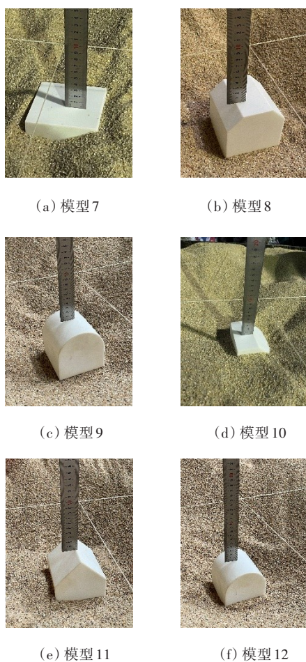
图13 室内空洞模型试验示意图
