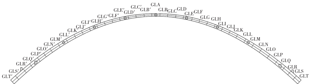
图1 拱肋节段划分图 Fig. 1 Arch rib segment division diagram
