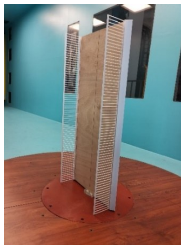
图5 主梁三分力系数试验图
