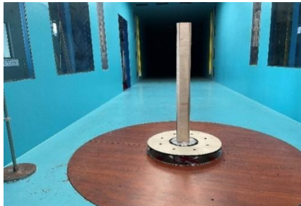
图9 桥塔三分力系数测试图
