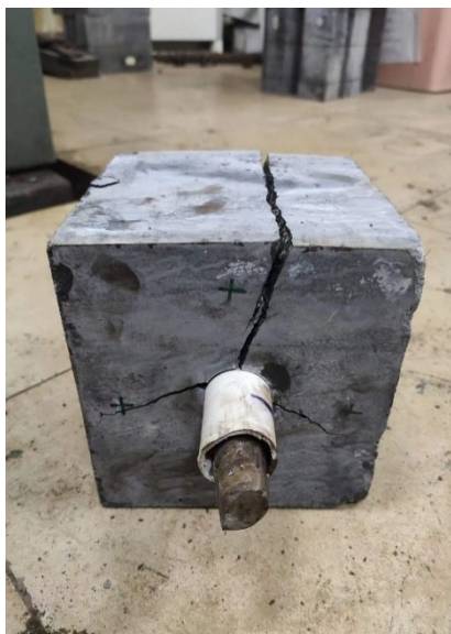
图4 UHPC-CA破坏模式(劈裂破坏)
