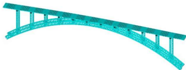
图6 涂乍特大桥有限元模型图
