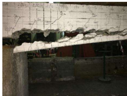
图9 增设无预应力段的加固试件P-L1400+600的破坏形态
