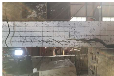
图7 预应力加固试件P-L2000的破坏形态
