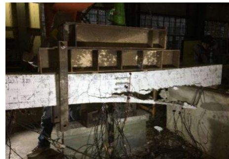
图6 非预应力加固试件N-L2000的破坏形态
