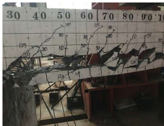
图 12 增设无预应力段加固试件 P-L1400+800 的破坏形态
