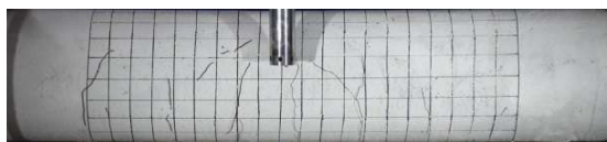
图2 试件 CRC11-10 破坏形态
