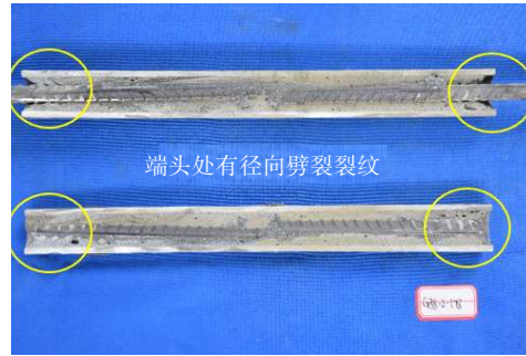
(d) G38-2-178 试件破坏剖面
