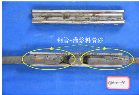
(a) G30-0-90 试件破坏剖面
