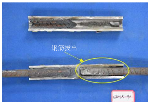
(b) G30-1.5-90 试件破坏剖面
