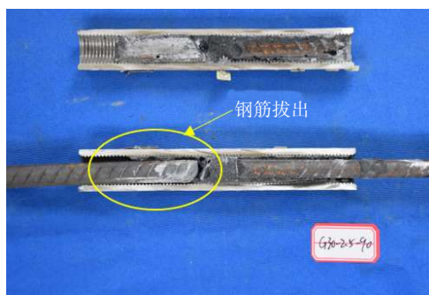
(d) G30-2.5-90 试件破坏剖面
