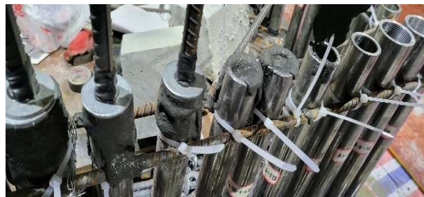
图1 试件灌浆示意图
