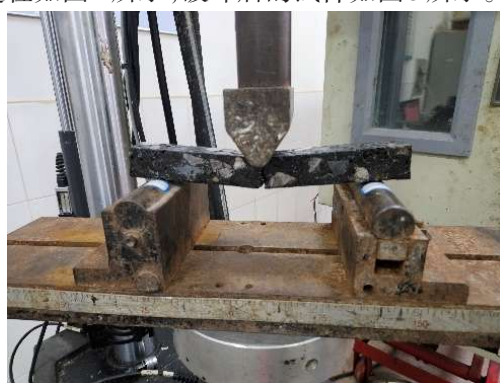
图2 小梁弯曲试验
