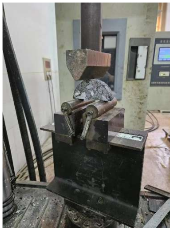
图5 半圆弯拉试验
